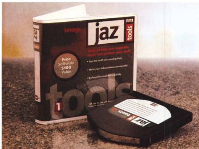
La cartuccia della capacità di 1 Gigabyte utilizzata dallo Jaz mantiene dimensioni molto ridotte, rimuovendo la finestrella anteriore è possibile vedere i due supporti che assicurano l'immagazzinamento dei dati.
